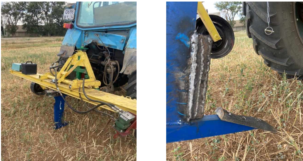
Рисунок 7 – Общий вид экспериментальной установки по определению тягового сопротивления рабочей секции чизельного орудия
