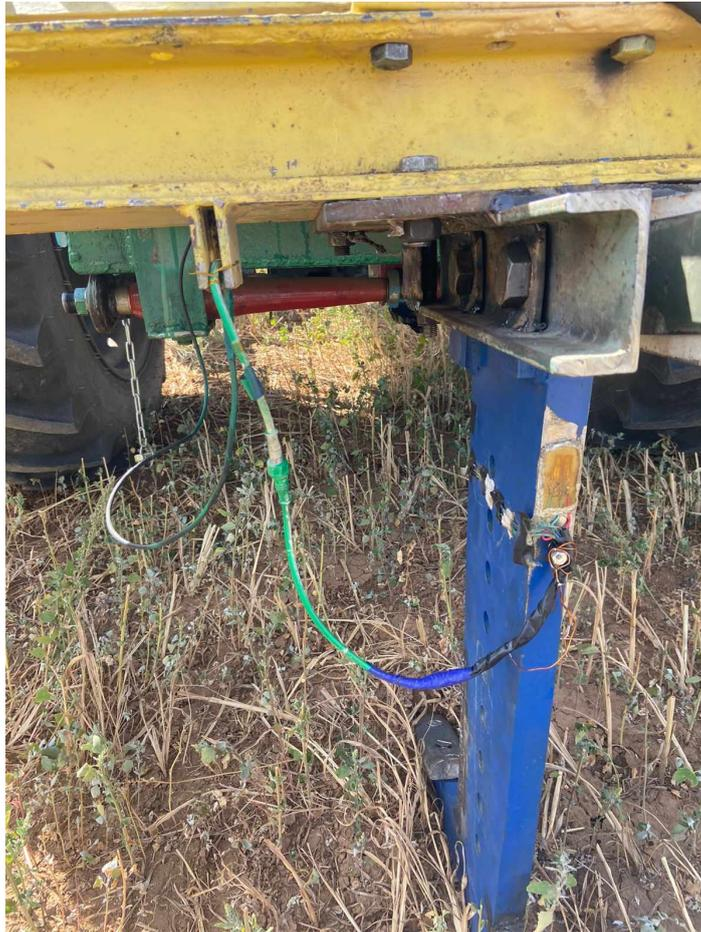
Рисунок 3.9 – Устройство для измерения тягового сопротивления чизельной стойки.
