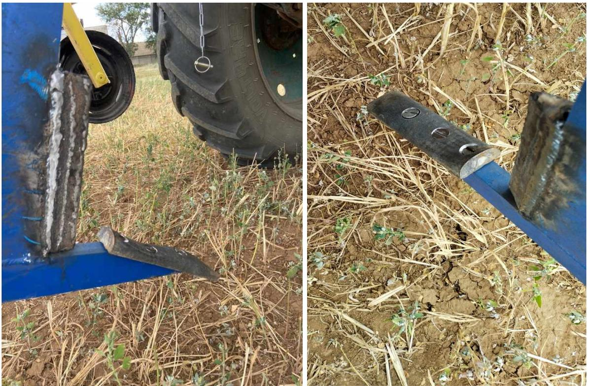
Рисунок 3.4 Общий вид экспериментальных рабочих органов чизельного плуга.
