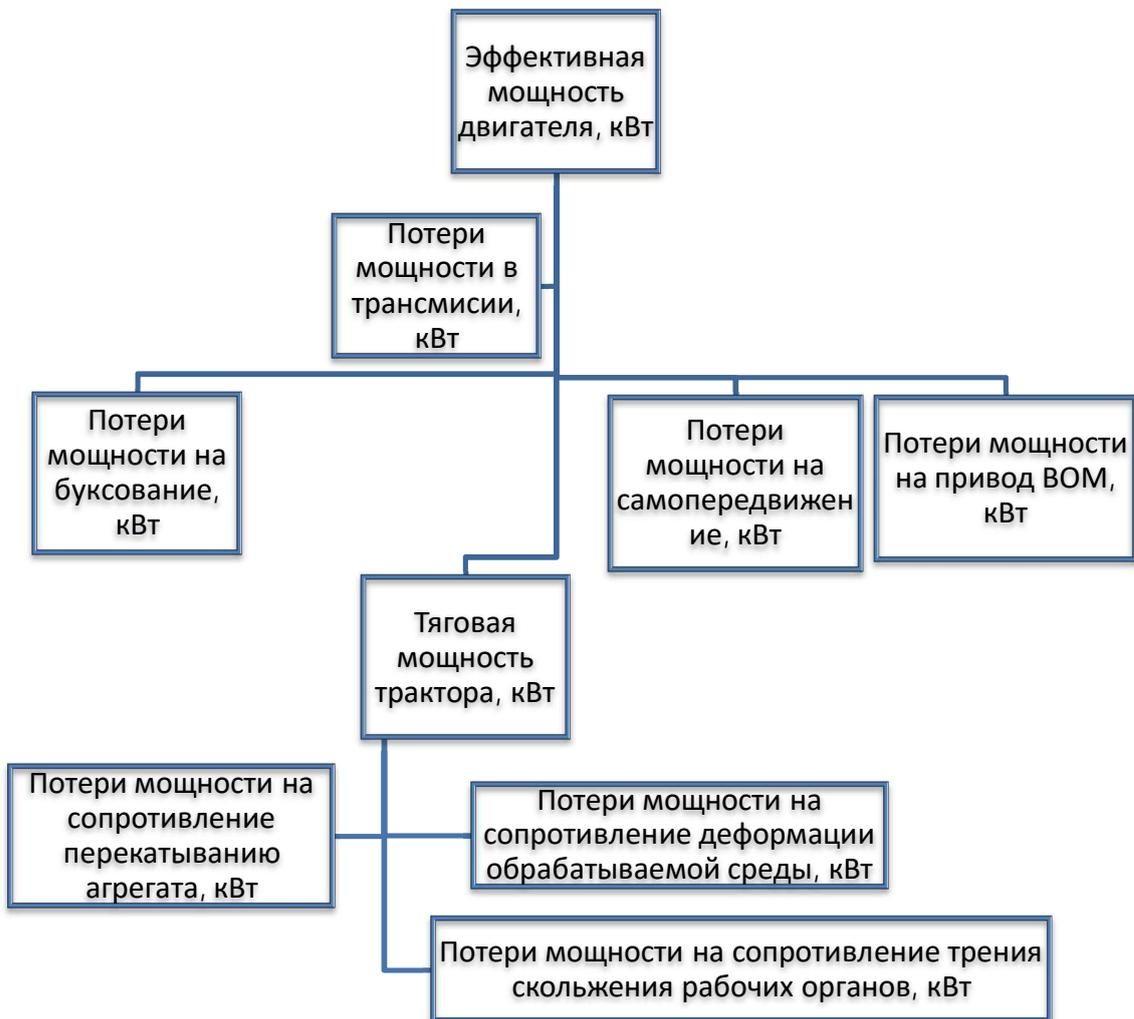
Рисунок 1.1 – Структурная схема формирования показателя удельного расхода топлива.
