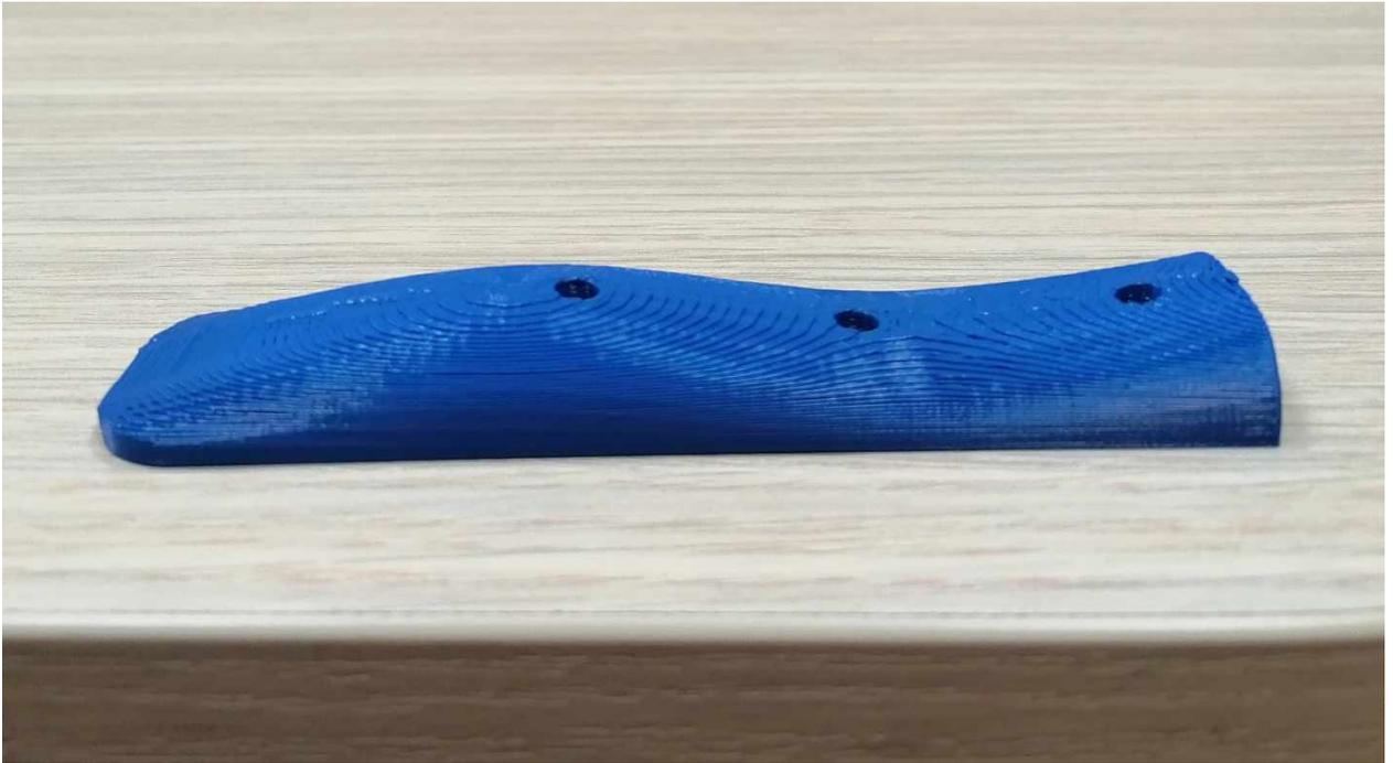
Рисунок 3.2 – Модель экспериментального рабочего органа, полученная посредством 3D - печати.
