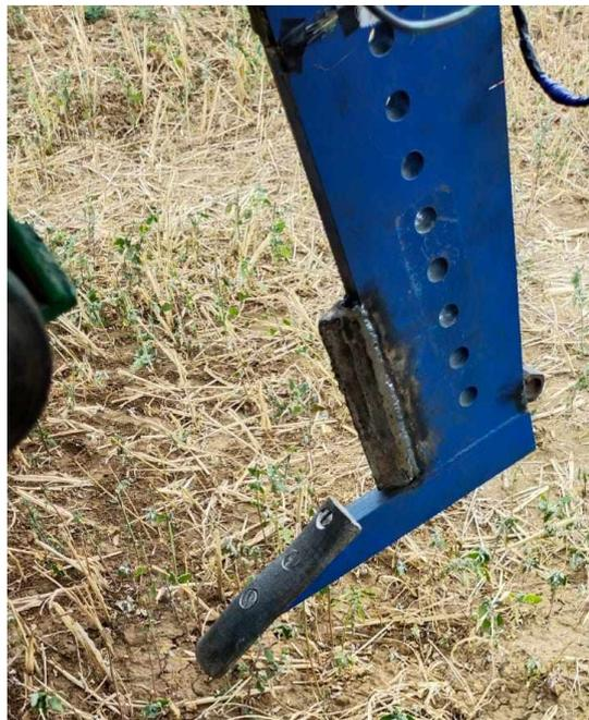
Рисунок 2.1 – Рабочая секция чизельного плуга с улучшенной геометрией поверхности рабочего органа.
