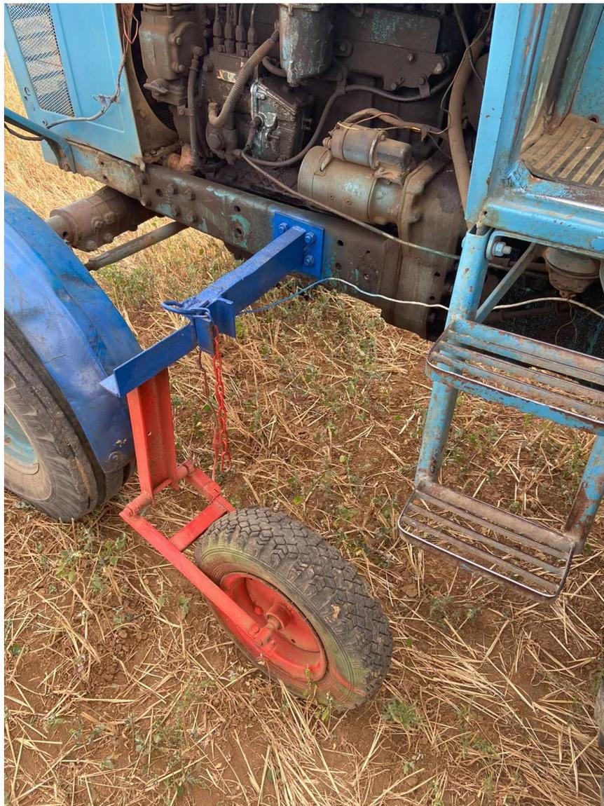
Рисунок 3.10 – «Регистрация действительной скорости движения экспериментальной установки».
