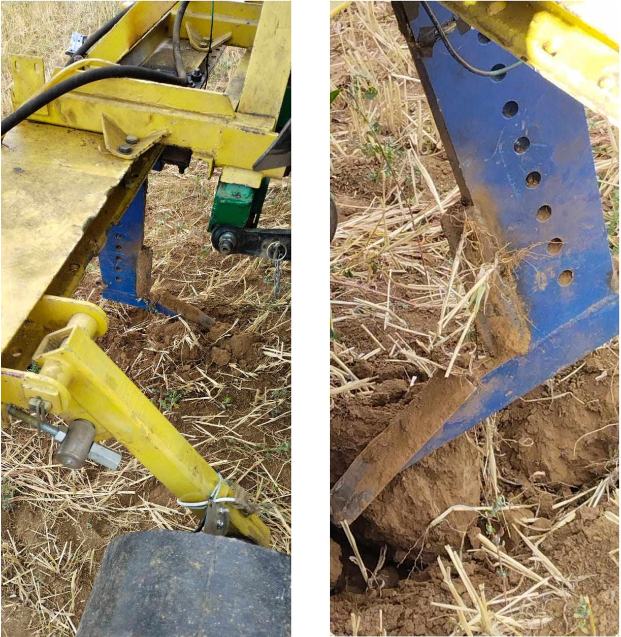
Рисунок 4.4 – Эффект налипания частиц почвы на экспериментальные рабочие органы. Влажность почвенного фона 16%.
