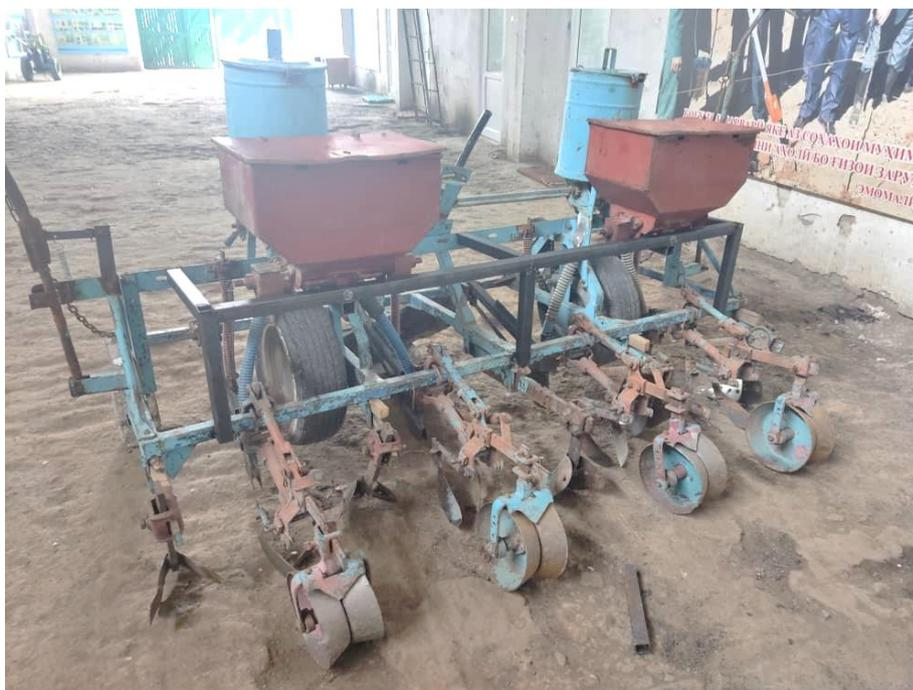
Рисунок 2.3 – Экспериментальный образец сеялки УСК-4 «НЦИТМ» (вид сзади)
