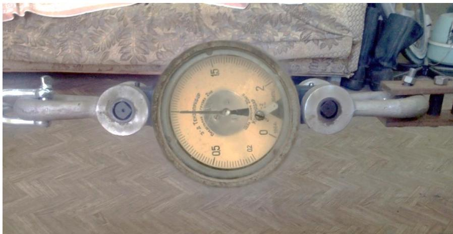
Рисунок 3.15 – Тарировка динамометра ДПУ-2 в лабораторных условиях
