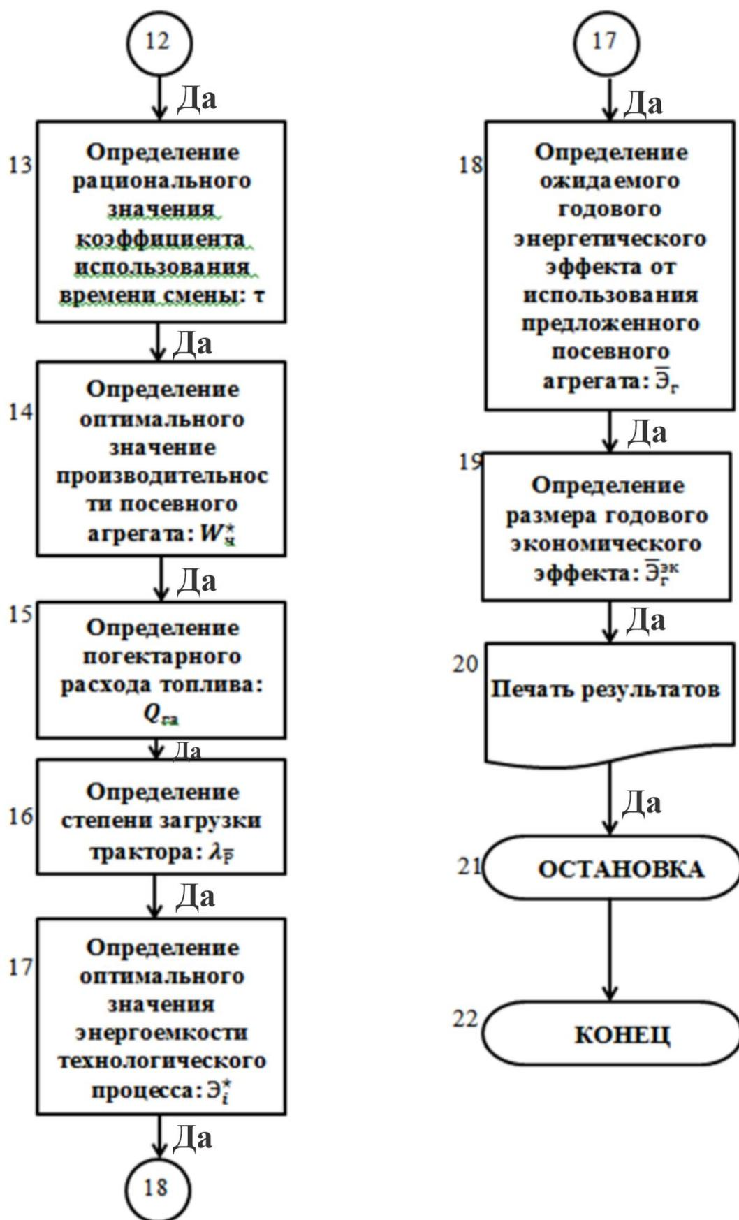
«Рисунок 2.16 - Блок-схема алгоритма определения оптимальных режимов работы МТА для посева пропашных культур (конец)» [91]
