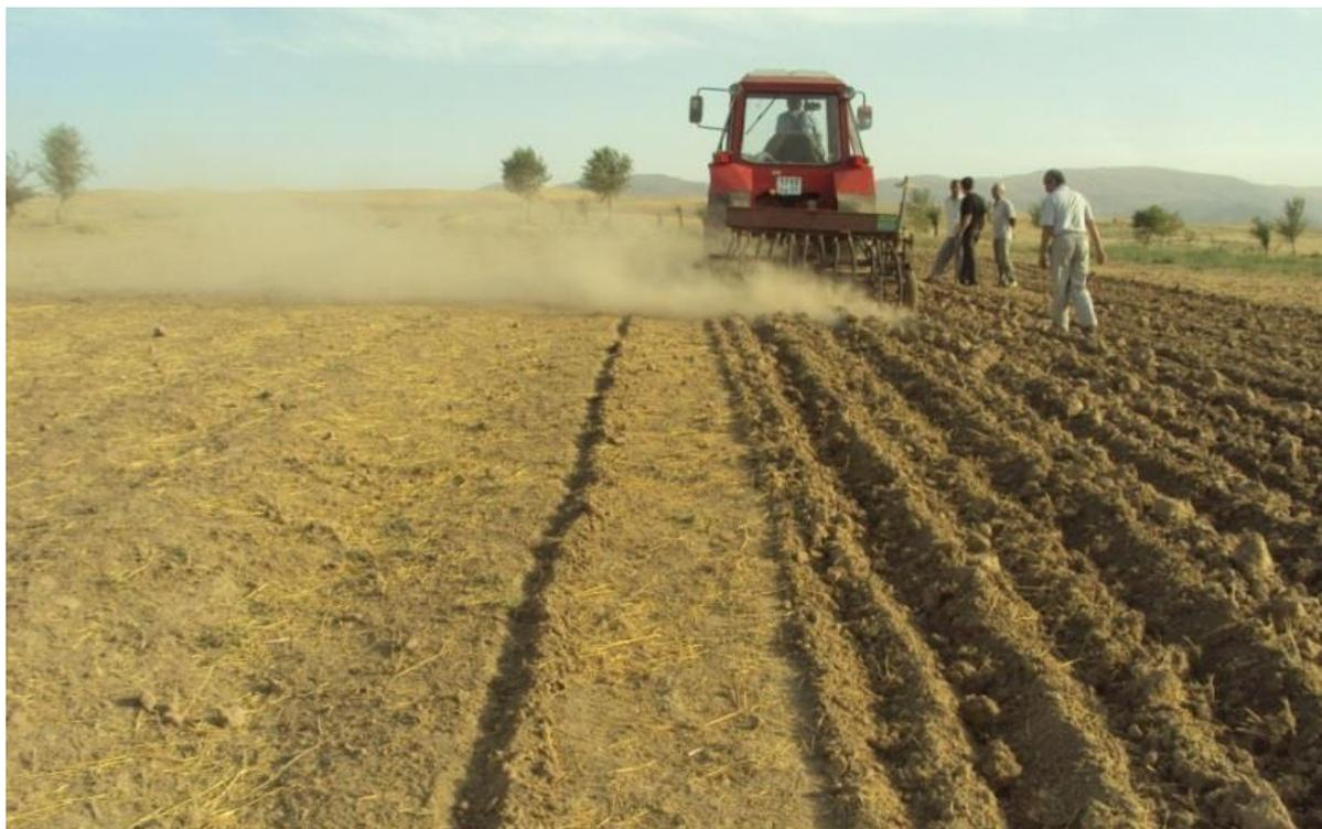
«Рисунок 1.8 – Общий вид комбинированного почвообрабатывающего-посевного агрегата МТЗ-82.1+КМ-1,8 «Кишоварз» при выполнении технологического процесса» [12]
