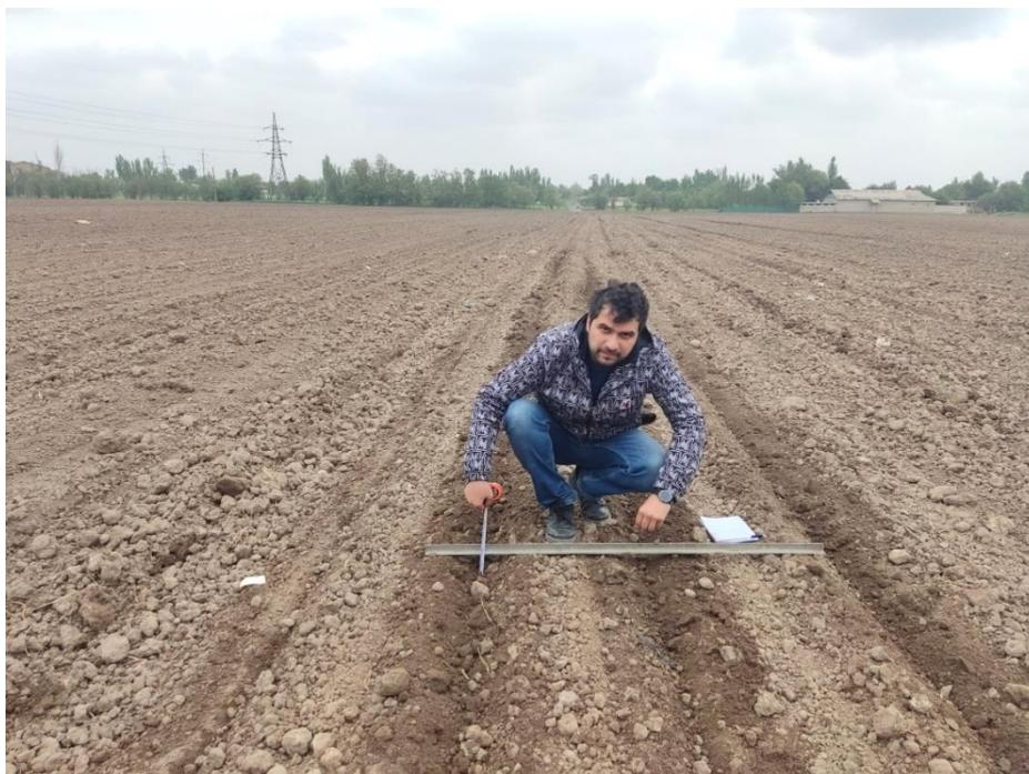
Рисунок 3.13 – Измерение глубины поливной борозды
