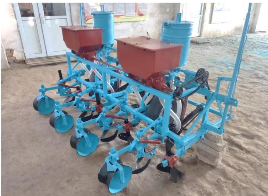
«Рисунок 2.4 – Общий вид усовершенствованной универсальной комбинированной сеялки УКС-2,4 (вид сзади)» [88]
