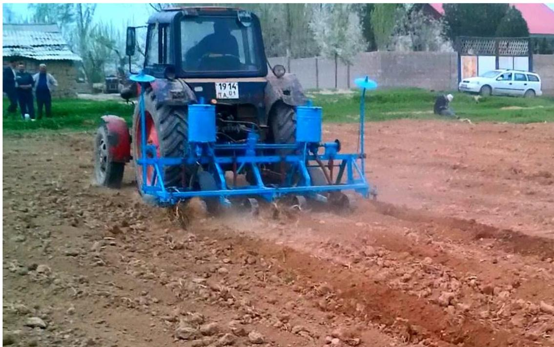
Рисунок 2.1 – Экспериментальный образец сеялки (вид сзади) во время выполнения технологического процесса посева семян пропашных культур в агрегате с трактором МТЗ-80
