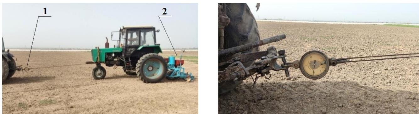
Рисунок 3.16 – Измерение тягового сопротивления посевного агрегата методом буксирования; 1-динамометр, 2-сеялка УКС-2,4 «НЦИТМ»
