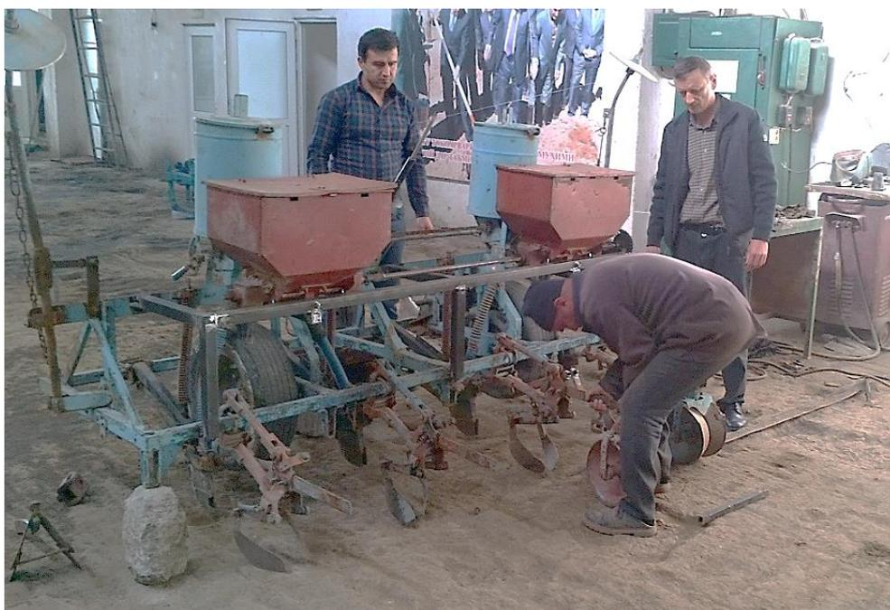
Рисунок 2.2 – Процесс добавления новых узлов и сборки экспериментальной сеялки для посева пропашных культур
