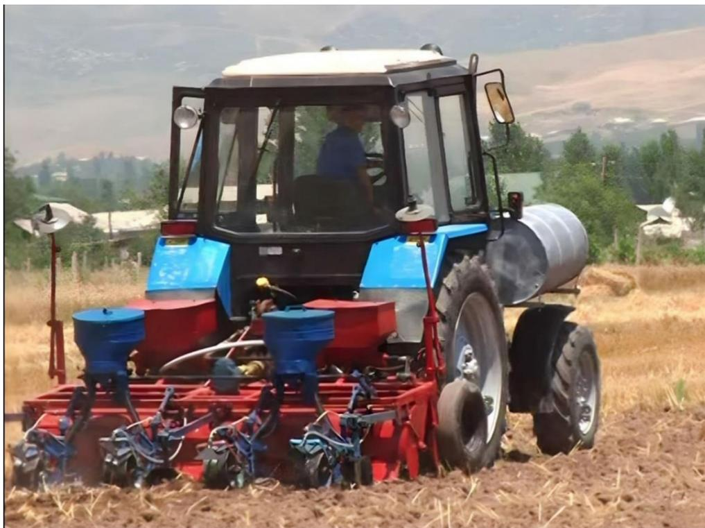
«Рисунок 1.10 – Общий вид комбинированной почвообрабатывающей-посевной машины КМ-2,4 «Кишоварз» в агрегате с трактором МТЗ-82.1» [12, 16]
