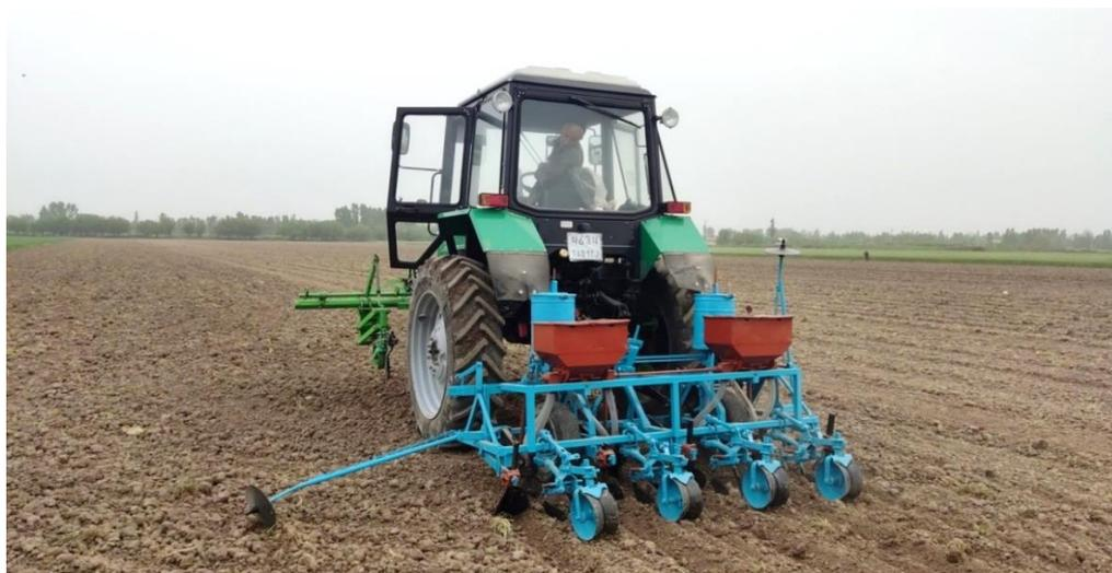
Рисунок 3.2 – Общий вид посевного агрегата МТЗ-80Х+УКС-2,4 «НЦИТМ» (вид сзади) при выполнении технологического процесса
