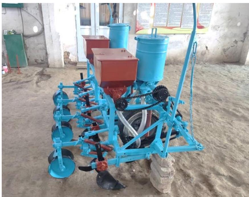
«Рисунок 2.5 – Общий вид усовершенствованной универсальной комбинированной сеялки УКС-2,4 (вид сбоку)» [88]
