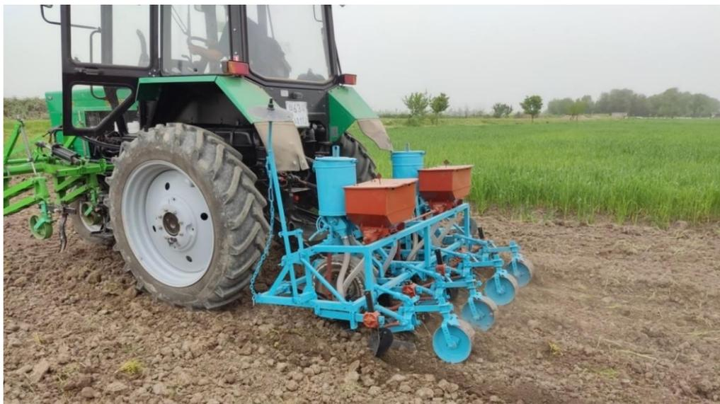
Рисунок 3.3 – Общий вид посевного агрегата МТЗ-80Х+ УКС-2,4 «НЦИТМ» (вид сбоку) при выполнении технологического процесса
