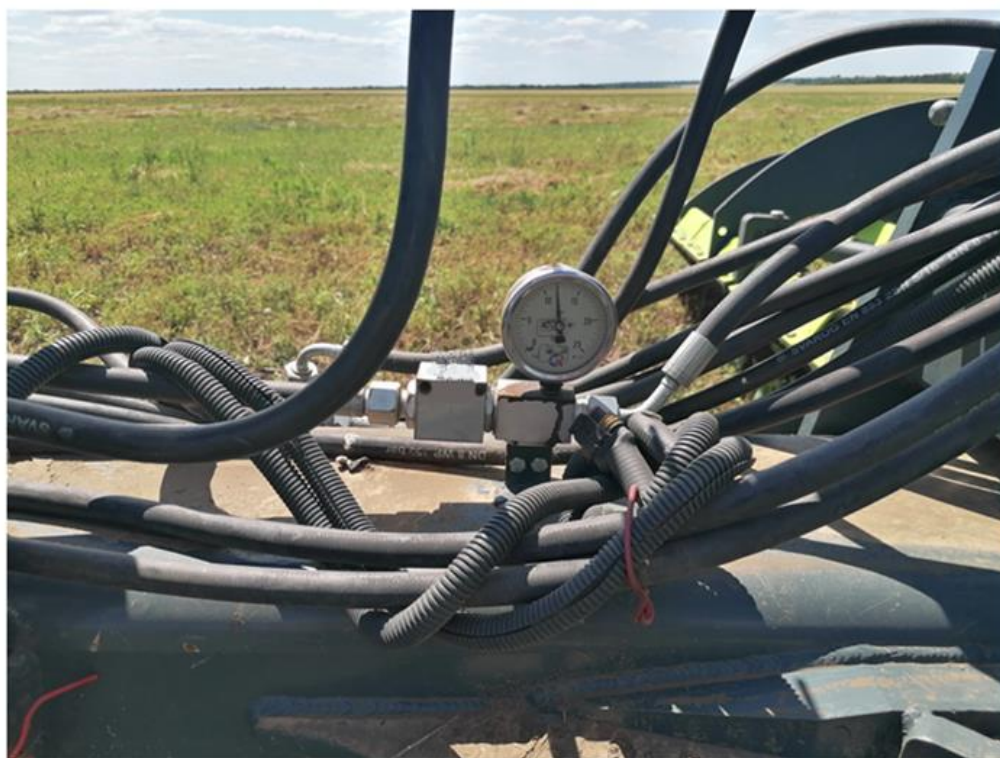
Рисунок 3.6 - Узел манометра с электромагнитным клапаном
