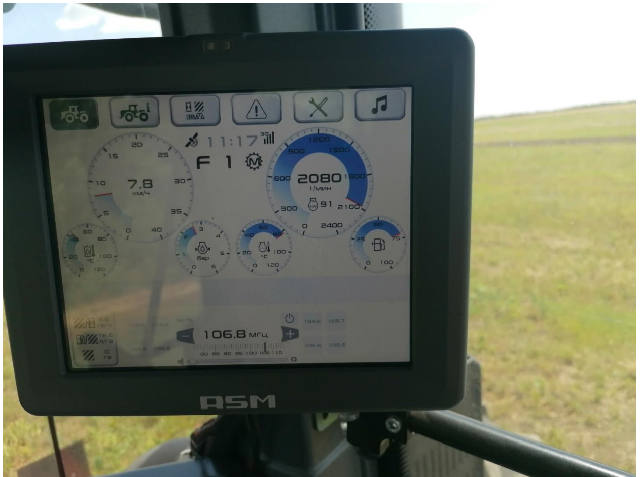
Рисунок 3.14 - Общий вид информационного экрана системы GPS мониторинга трактора
