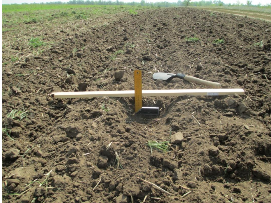
Рисунок 3.13 – Измерение глубины обрабатываемой поверхности
