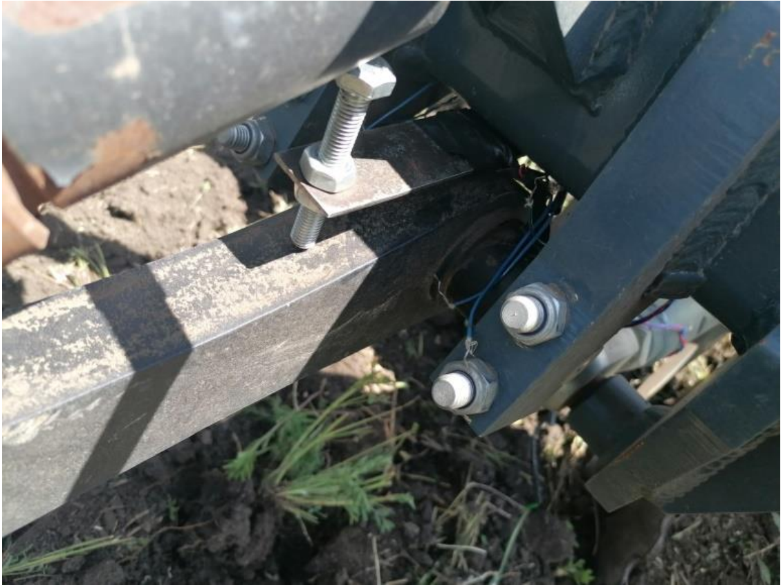
Рисунок 3.11 – Экспериментальная проверка работоспособности тензометрических датчиков
