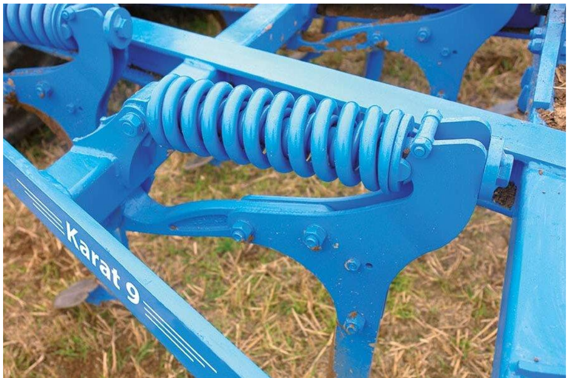
Рисунок 1.25 – Система защиты от перегрузок культиватора Karat 9
