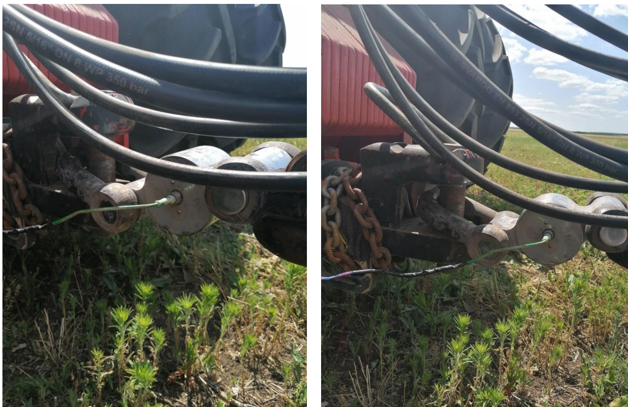
Рисунок 3.10 - Конфигурация прикрепленного к трактору тензометрического звена
